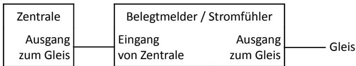
Abbildung 1: Belegtmelder (Eingang:Ausgang = 1:1)
