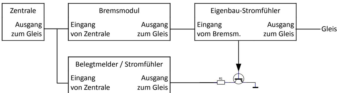
Abbildung 7: Zentrale → Bremsmodul → Eigenbau-Stromfühler → Gleis; mit Scheinlast für Belegtmelder
