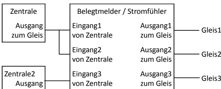
Abbildung 3: 1:1-Belegtmelder (Eingang : Ausgang = n : n = 1 : 1)
