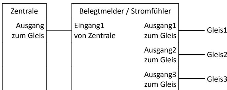
Abbildung 2: 1:n-Belegtmelder (Eingang : Ausgang = 1 : n)
