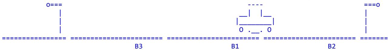
Sobald die Lok in B2 einfährt, gehen B3, B1 und B2 auf Bremsspannung, die Lok brems ab.
