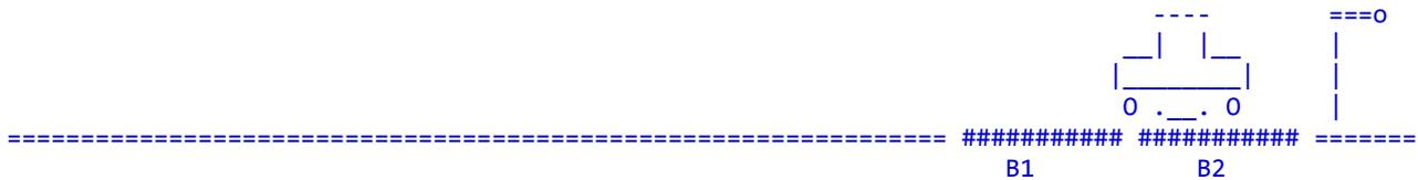
Die Umschaltung auf Bremsen erfolgt, sobald die Lok in den *ersten* Gleisabschnitt einfährt. Es liegt dann in beiden Gleisabschnitten Bremsspannung an.
