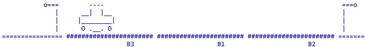
Die Umschaltung auf Bremsen erfolgt, sobald die Lok in den *dritten* Gleisabschnitt einfährt. Es liegt dann in allen drei Gleisabschnitten Bremsspannung an.
