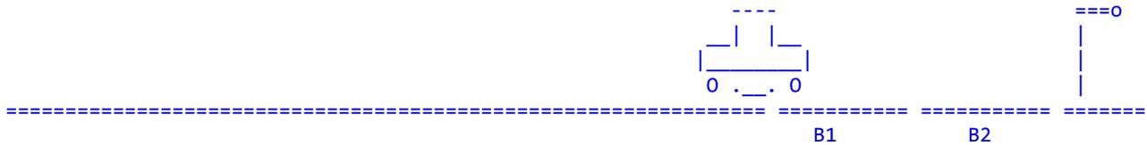
Sobald die Lok in B1 einfährt, gehen B1 und B2 auf Bremsspannung, die Lok bremst ab.
