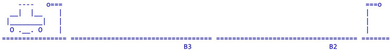
Sobald die Lok in B3 einfährt, gehen B3, (B1) und B2 auf Bremsspannung, die Lok bremst ab.
