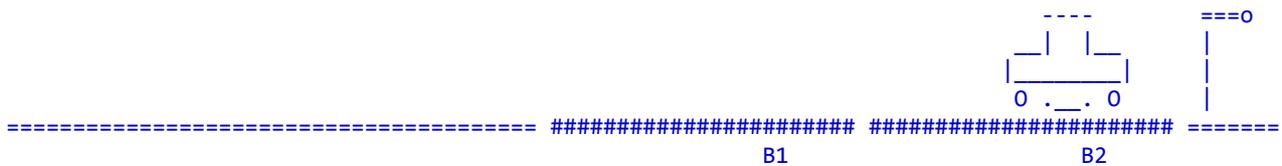
Die Umschaltung auf Bremsen erfolgt, sobald die Lok in den *zweiten* Gleisabschnitt einfährt. Es liegt dann in beiden Gleisabschnitten Bremsspannung an.
