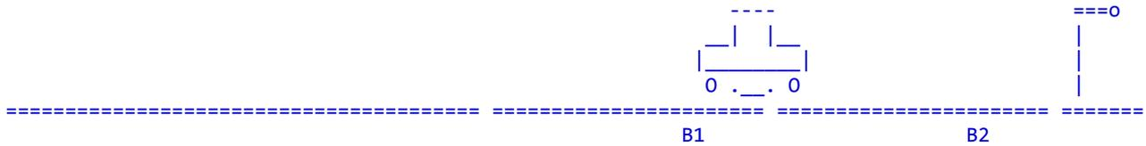
Sobald die Lok in B2 einfährt, gehen B1 und B2 auf Bremsspannung, die Lok bremst ab.
