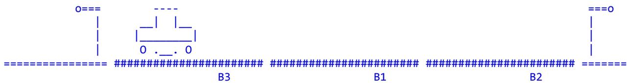
Die Umschaltung auf Bremsen erfolgt, sobald die Lok in den *dritten* Gleisabschnitt einfährt. Es liegt dann in allen drei Gleisabschnitten Bremsspannung an.
