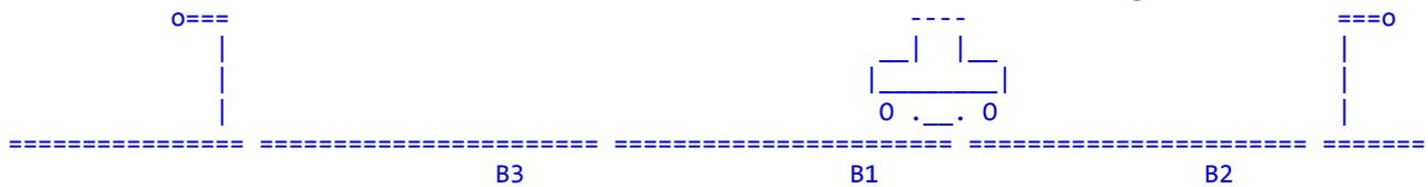
Sobald die Lok in B2 einfährt, gehen B3, B1 und B2 auf Bremsspannung, die Lok bremsst ab.
