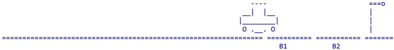
Sobald die Lok in B1 einfährt, gehen B1 und B2 auf Bremsspannung, die Lok brems ab.
