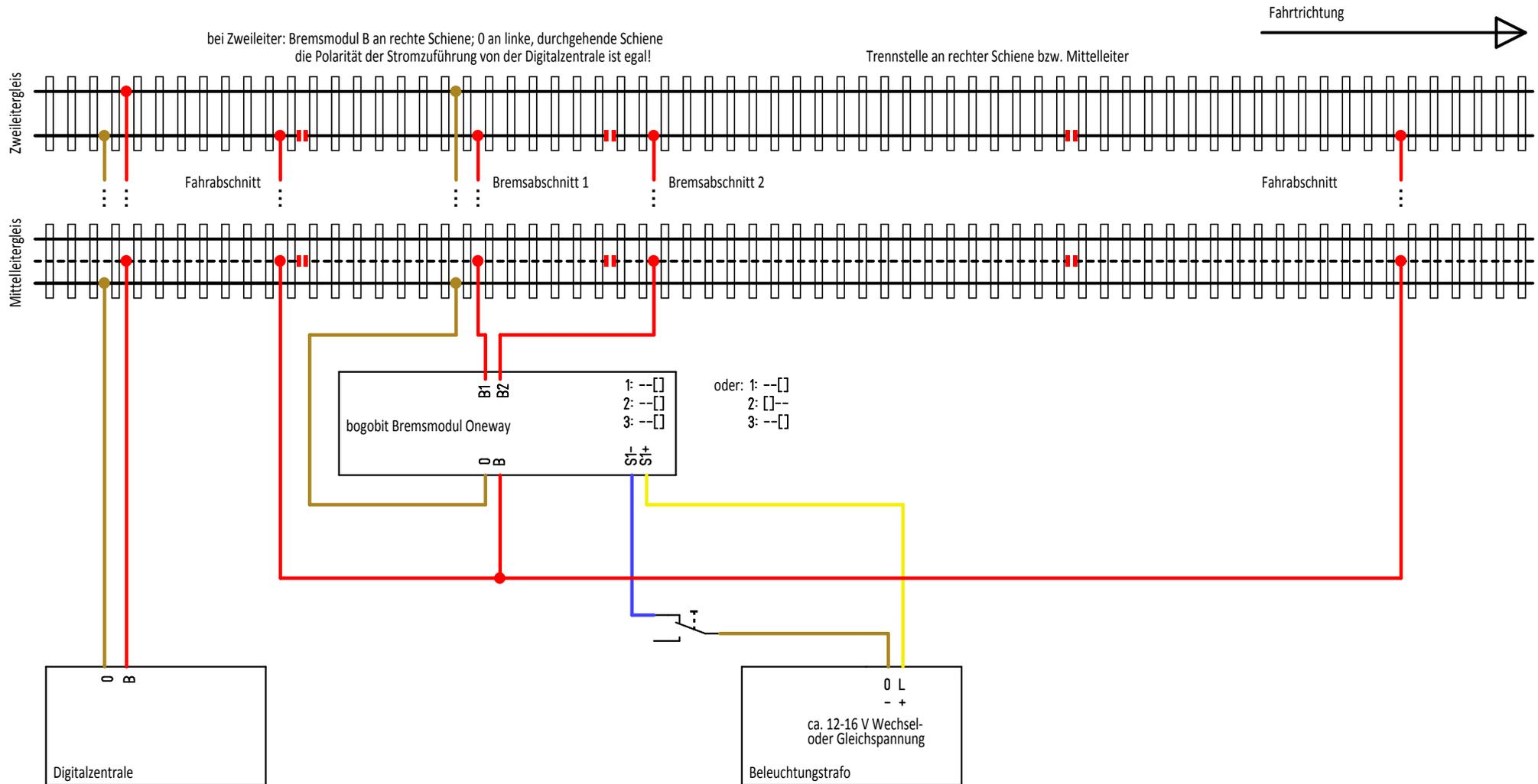
Der Schaltkontakt kann mit einem Schalterpult oder Schaltdecoder realisiert werden
