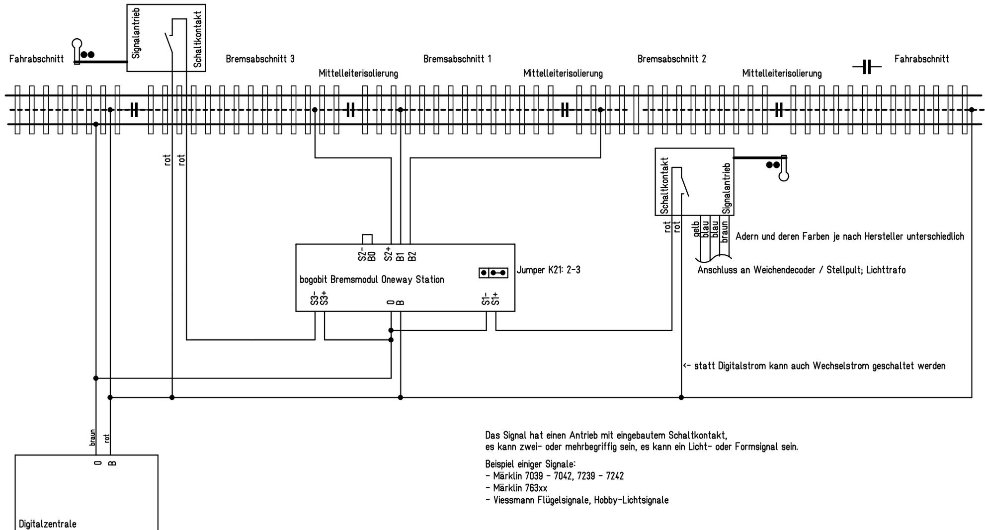
Statt eines Signals kann der Schaltkontakt mit einem Schaltpult oder Schaltdecoder realisiert werden
