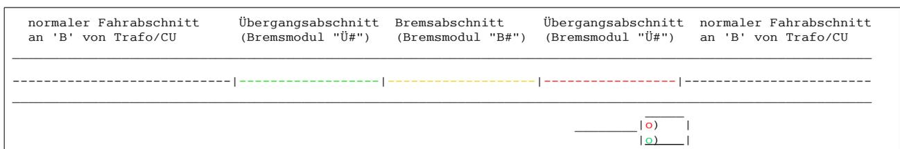
Die Umschaltung des Bremsmoduls zwischen den Zuständen „Fahrt“ und „Bremsen“ erfolgt über die Steuereingänge "R\*", "RR" und "RG". Diese sind an ein Stellpult (zwei Momentkontakte) oder an einen Märklin Weichendecoder anzuschließen.
