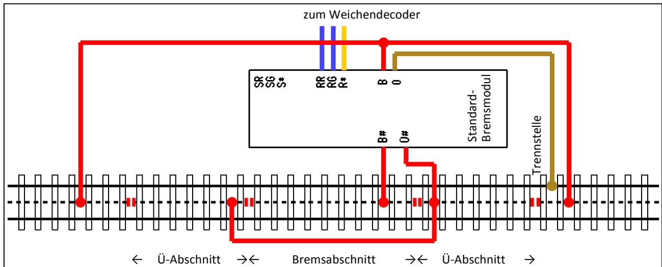
Die Umschaltung des Bremsmoduls zwischen den Zuständen „Fahrt“ und „Bremsen“ erfolgt über die Steuereingänge "R\*", "RR" und "RG". Diese sind an ein Stellpult (zwei Momentkontakte) oder an einen Märklin Weichendecoder anzuschließen.
